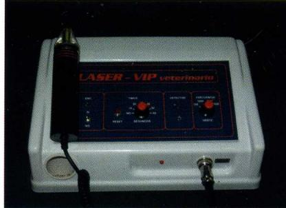
Equipo de láser de arseniuro de galio de 904 nm.
